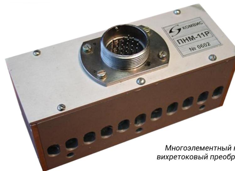
Многоэлементный накладной вихретоковый преобразователь
