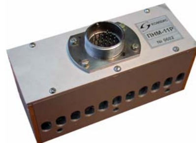
Рис. 9. Многоэлементный накладной ВТП из комплекта дефектоскопа ВД-516ЦТ
