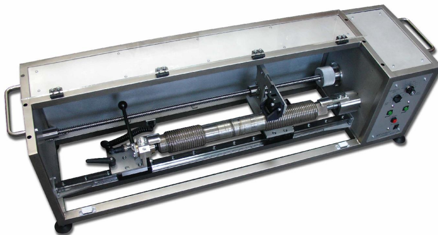
Рис. 7. Сканирующее устройство СКР-64Н для контроля шпилек
