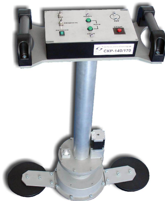
Рис. 6. Манипулятор СКР-140/170 для контроля резьбовых отверстий
