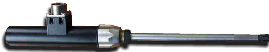
Рис. 4. Вращающийся вихретоковый преобразователь ПНВ-3 для контроля перемычек коллекторов ПГ.
