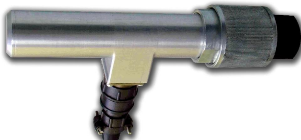
Рис. 8. Вращающийся вихретоковый преобразователь ПНВ-4 для контроля сварных швов приварки ТОТ к коллектору ПГ
