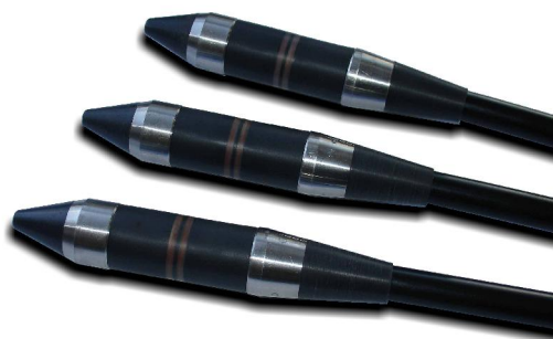
Рис. 3. Вихретоковые преобразователи для контроля ТОТ конденсаторов турбин
